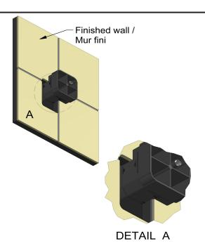
Wall template cut out, finished wall. / Gabarit de mur pour découpage, mur fini.
